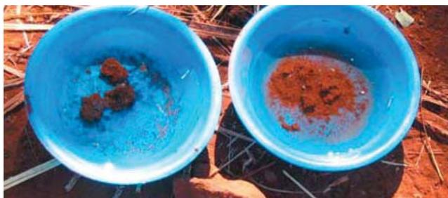
**Figura 3: Um teste de campo sobre a estabilidade agregada. Pequenos torrões de terra de um campo arado (direita) e terra virgem (esquerda) foram colocados cuidadosamente na água. Os torrões de cor mais clara do campo arado desintegram-se, enquanto os torrões do solo virgem permanecem intactos.**
